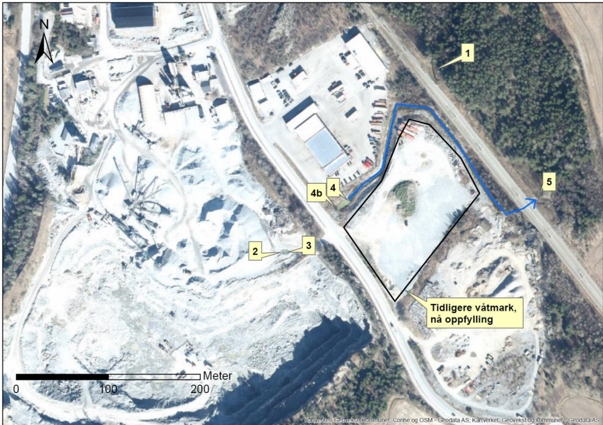
Figur 2. Flyfoto med oversikt over de ulike lokasjonene for prøvetaking med sedimentasjonsbasseng, men etter fjerning av våtmark.
