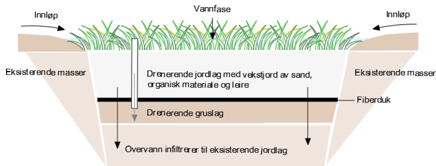
Figur 13 – Prinsippskisse av oppbyggingen av regnbed.
