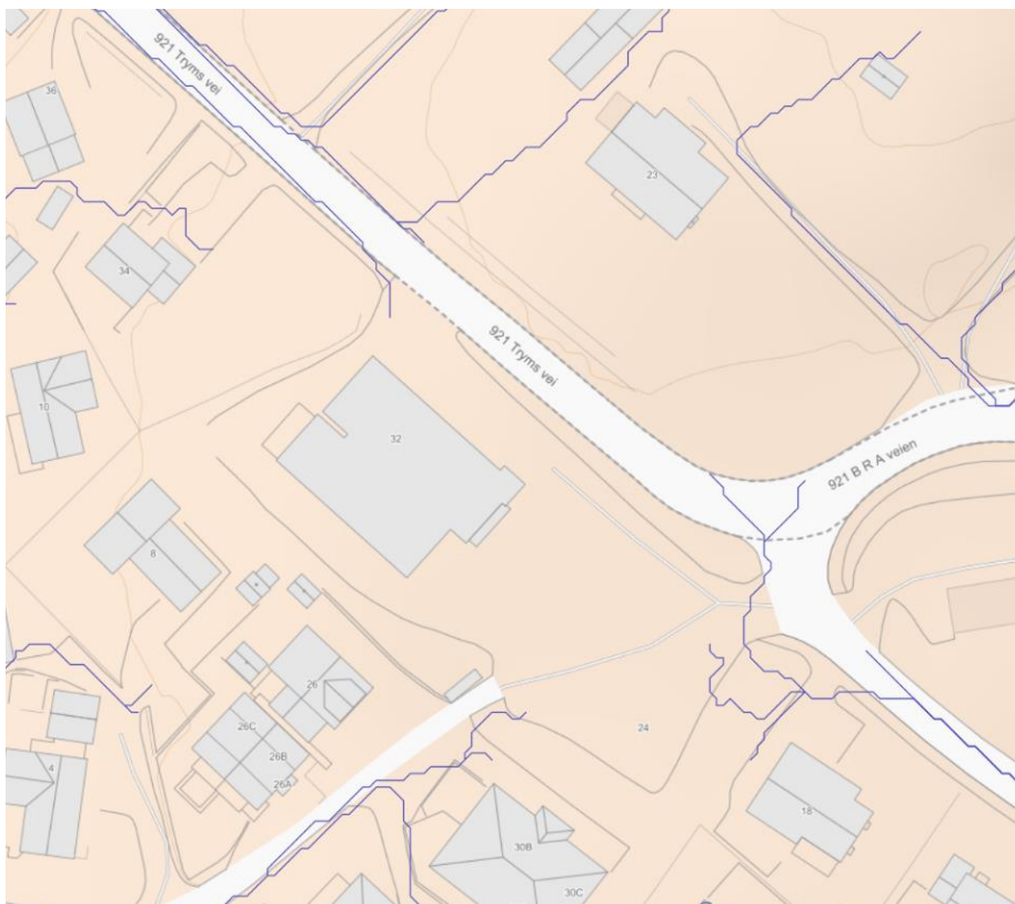
Figur 10 - Utklipp fra SCALGO Live som viser hvor flomveien trolig går (blå linjer) i nærheten av eiendommen i eksisterende situasjon (SCALGO Live, 2022).
